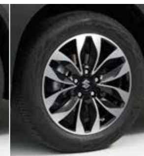
4 | Zliatinový disk kola „MISTI“ 6,5 J x 17“ Vhodné pre pneumatiky 215/55 R17, vrátane stredovej krytky s logom S, certifikácia ECE-R 124. Matná čierna Obj. čís. 990E0-61M76-002 Leštená čierna Obj. čís. 990E0-61M78-002
